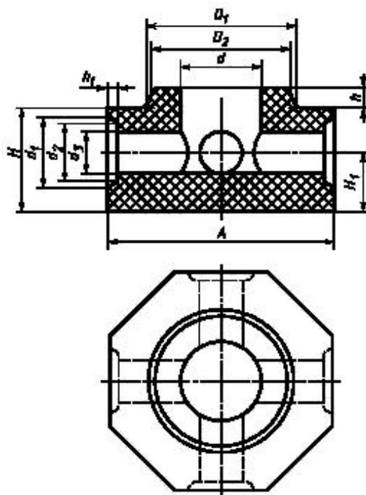
Рисунок 6 — Прямоугольная четырехходовая звездочка с буртиком
