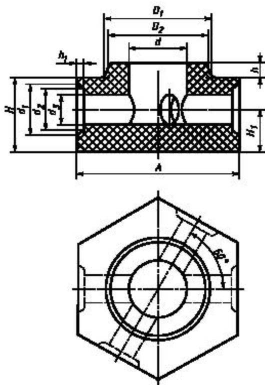
Рисунок 8 — Косоугольная четырехходовая звездочка с буртиком
