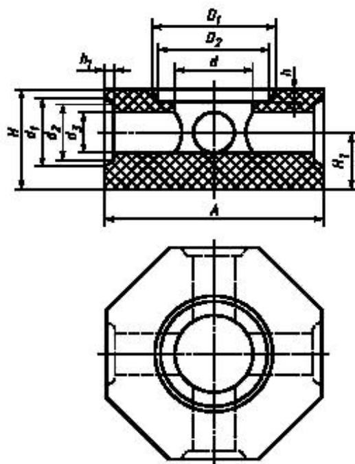
Рисунок 5 — Прямоугольная четырехходовая звездочка с пазом
