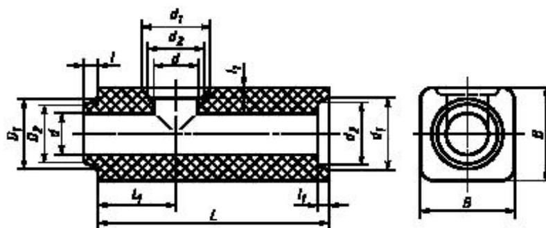
Рисунок 14 — Пролетная сифонная трубка с боковым отверстием
