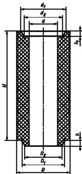
Рисунок 2 — Центровая трубка
