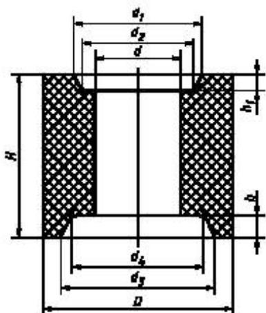
Рисунок 3 — Центровая трубка с двумя пазами
