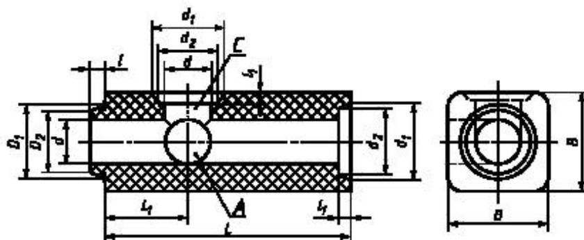
Рисунок 15 — Пролетная сифонная трубка с двумя боковыми отверстиями
