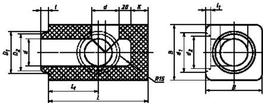
Рисунок 21 — Сифонная трубка с боковым отверстием
