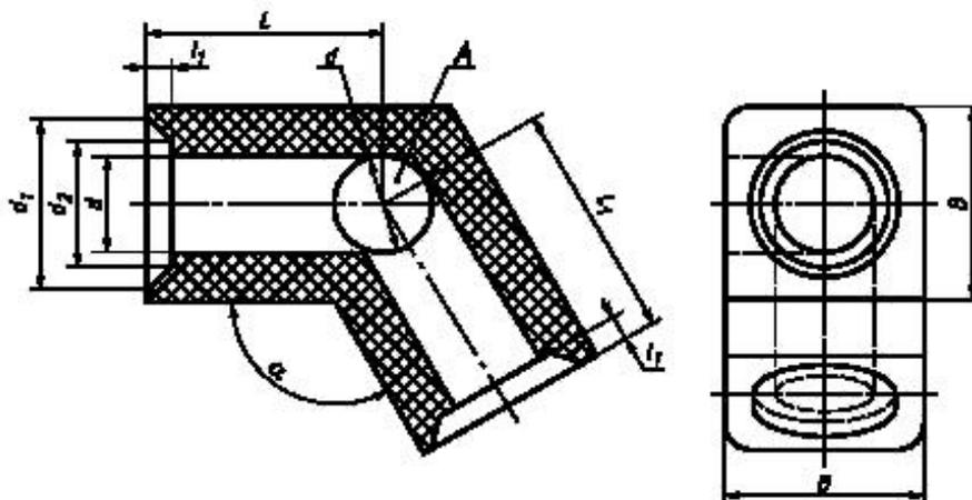
Рисунок 19 — Угловая сифонная трубка
