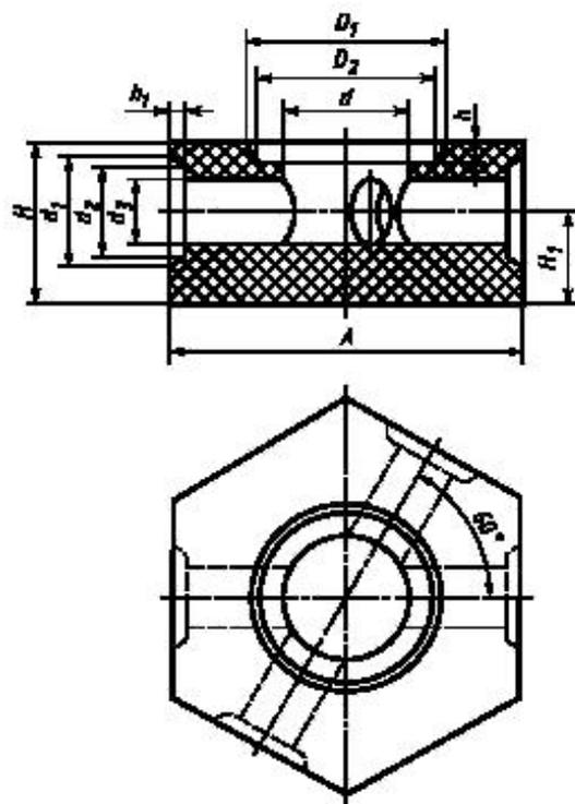
Рисунок 7 — Косоугольная четырехходовая звездочка с пазом
