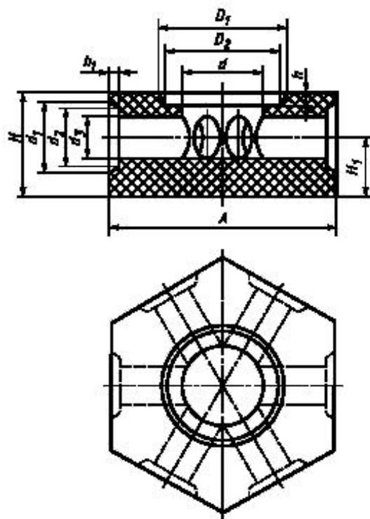
Рисунок 9 — Шестиугольная звездочка с пазом
