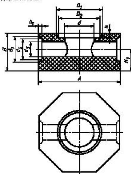
Рисунок 4 — Двухходовая звездочка с пазом
