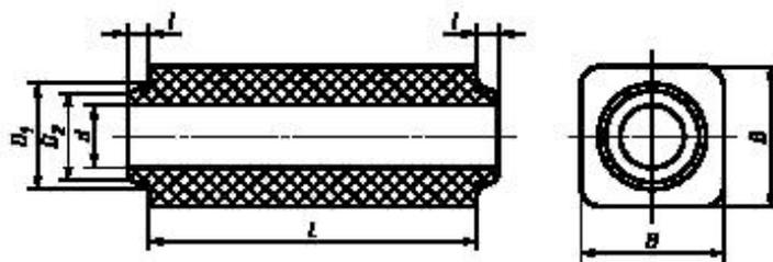
Рисунок 13 — Пролетная сифонная трубка с двумя буртиками
